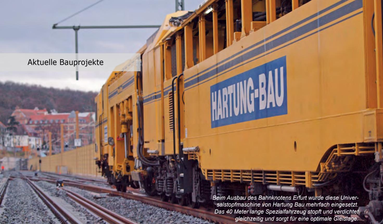
Beim Ausbau des Bahnknotens Erfurt wurde diese Universalstopfmaschine von Hartung Bau mehrfach eingesetzt. Das 40 Meter lange Spezialfahrzeug stopft und verdichtet gleichzeitig und sorgt für eine optimale Gleislage.
