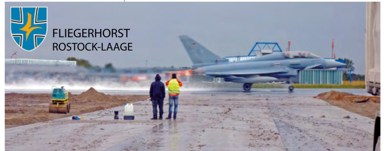
Deutschland in langjähriger Entwicklungszeit konstruiert wurde, liegen auf der Hand, bzw. in der Luft: In weniger als zwei Minuten nach Lösen der Bremse auf der Startbahn kann der zweistrahlige Kampfjet auf mehr als 1.000 Meter Höhe steigen, je nach Zuladung auch senkrecht. In optimaler Höhe erreicht der „Ferrari der Lüfte“ eine Geschwindigkeit von Mach 2 oder 2150 Stundenkilometern.
